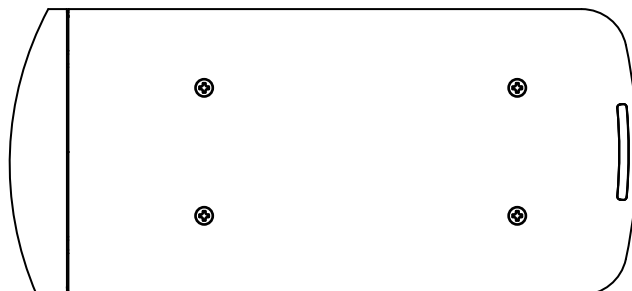
Figura 8 Cuatro tuercas de barril en la cúpula del extremo del lado del acompañante
