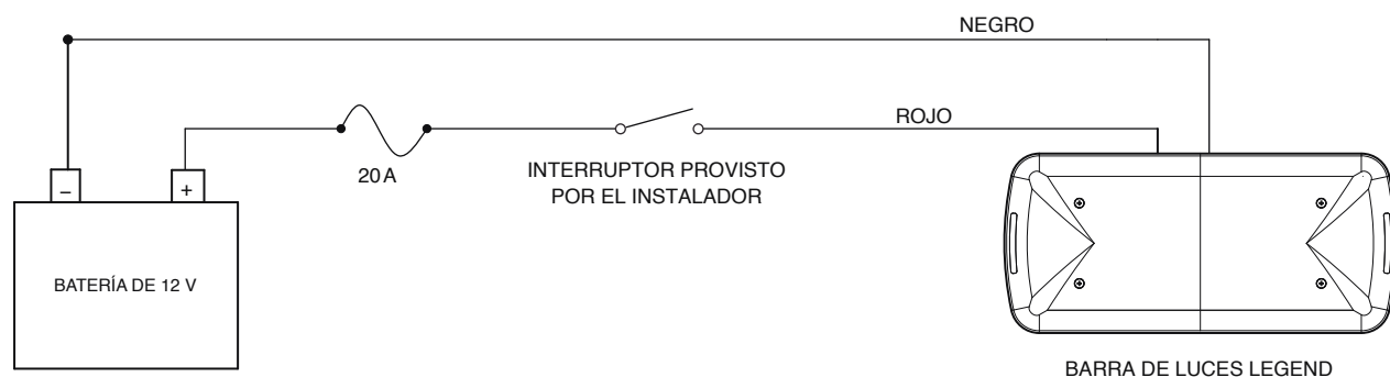
Diagrama esquemático A.1: Barra de luces Legend de 24" con cableado discreto
